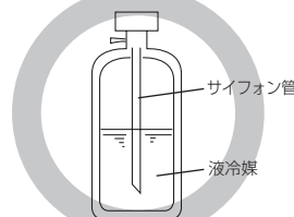
【サイフォン管付きボンベの場合(立てたまま液冷媒を充てんできる)】
