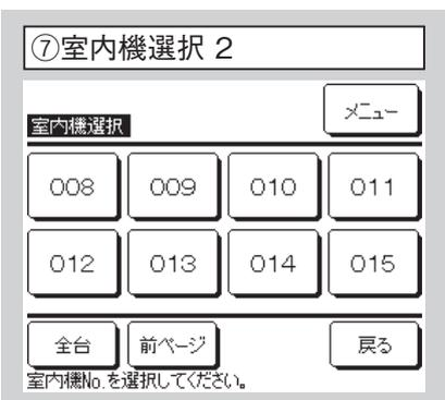
複数室内ユニットを接続の場合、接続された室内ユニットが表示されます。
