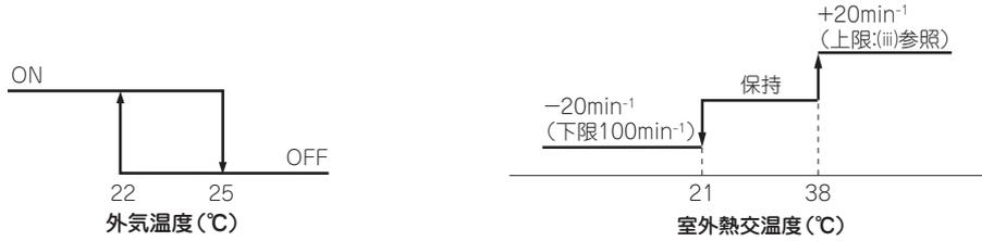
(i) 外気温度が $22^\circ\text{C}$ 未満で、室外ファンがONのとき室外ファンタップを固定します。
