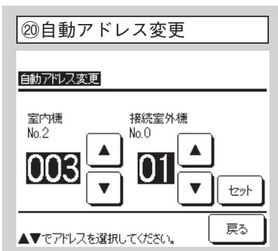
個別発停マルチシリーズで使用の際に自動アドレス設定で登録されている場合に操作できます。室内ユニット毎の室内外アドレスを変更するための機能です。室内ユニットを選択して [変更] をタッチすると右の新アドレス入力画面に変わります。[セット] をタッチすると左画面に戻り新アドレスが表示されます。[確定] をタッチすると登録されます。
