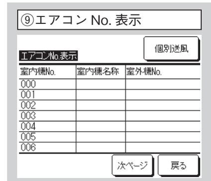
8台以上接続の場合は、次ページ以降に表示が出来ます。室内ユニット選択後[個別送風]ボタンをタッチすると、選択した室内ユニットが送風運転します。
