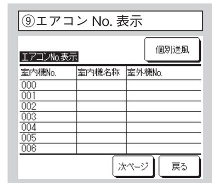
8台以上接続の場合は、次ページ以降に表示が出来ます。室内ユニット選択後**個別送風** ボタンをタッチすると、選択した室内ユニットが送風運転します。⇒⑩
