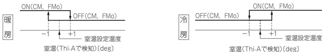
注(1) リモコンセンサ有効時はリモコンセンサ (Thc) にて検知。
