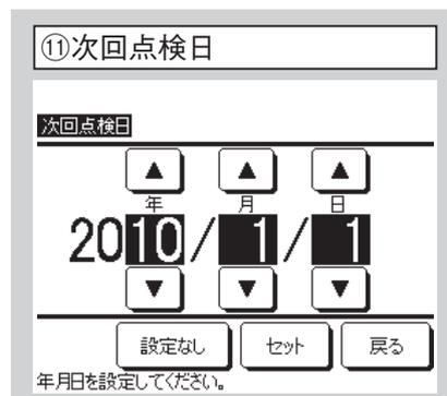
次回点検日を入力すると、点検月の運転開始/停止時メッセージが表示されます。表示は、次回点検日を更新するとリセットされます。
