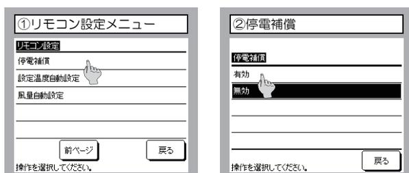
●常にリモコンの状態を記憶しており停電から復帰後、記憶内容により運転を再開します。ただしタイマーモードはキャンセルされますが、ウィークリータイマー、ピークカットタイマーおよび室外静音タイマーについては下記内容となります。
