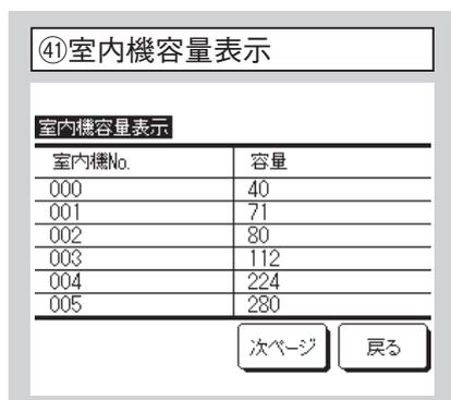
リモコンに接続されている室内ユニットの容量を表示します。
