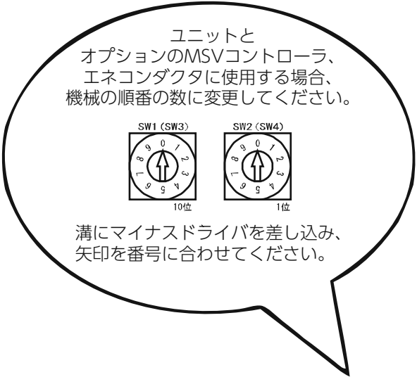
ユニット統括基板の アドレススイッチ SW1, SW2, SW3, SW4
