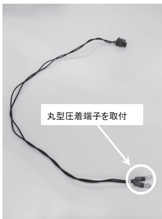
写真 1 ハーネスに丸型圧着端子を取付
