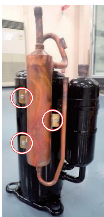
(d) オイルセパレータアセンブリ固定箇所
