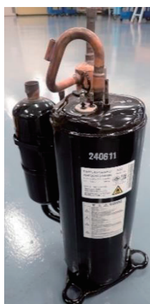
(c) 圧縮機 (取外し後)
