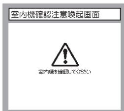
●リモコンと室内ユニット間の通信が確立できない場合に表示します。
