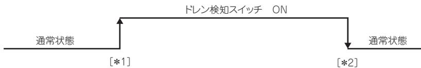
[\*1] ドレン検知可能区間においてフロートスイッチ「開」を3秒間連続検知した時、ドレン検知スイッチを「ON」にします。
