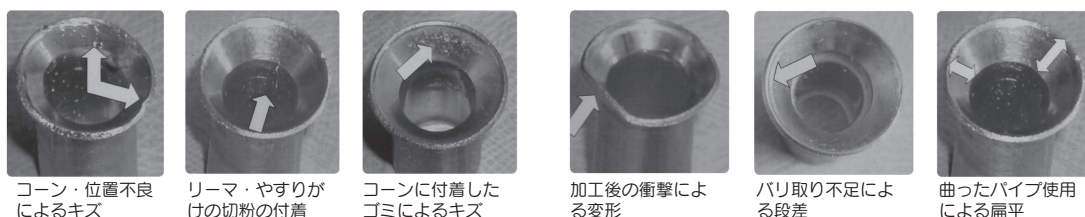
図2 フレア加工の不具合例
